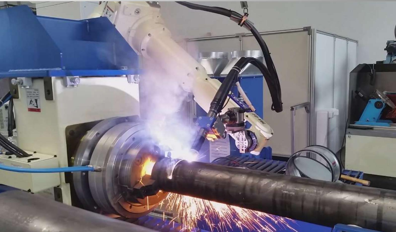
**SM Robotertechnik & Automation GmbH** bietet mit seinen **CUTSYS** Systemen eine echte Alternative im Bereich Trennen und Schneiden.
