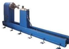
Drehkipptisch mit verstellbarem Gegenlager
