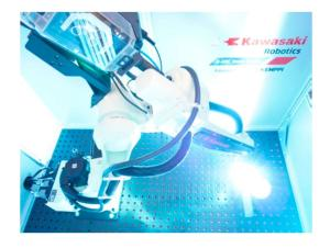
schnelle Einrichtung, Bauteile mit einfachen Spannmitteln zu fixieren Siegmund Spannsystem
