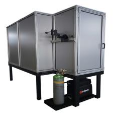
Medienwechsel von Ausen zugänglich Gasflaschenhalter auf der Zellenausenseite mit Auflage
