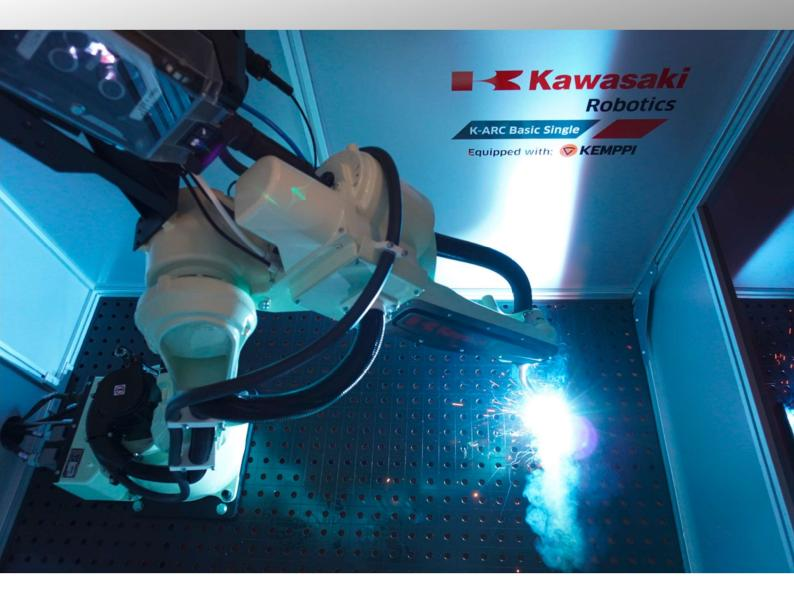
SM Robotertechnik & Automation GmbH bietet mit seiner S-ARC Serie eine komplette, schlüsselfertige Zellenlösung für Ihre Produktion. Alles, was Sie benötigen, in einer kompakten Zelle. Geeignet für MIG/MAG-Schweißen, flexibel und angetrieben von einem Kawasaki Robotics BA006N Lichtbogenschweißroboter und anderen hochwertigen Komponenten.
